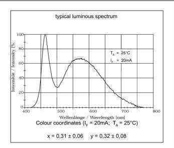
Elektrische und optische Daten sind bei einer Umgebungstemperatur von 25°C gemessen. Electrical and optical data are measured at an ambient temperature of 25°C.
